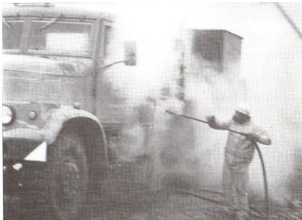
Дезактивация техники на ПУСО пароводяным способом
