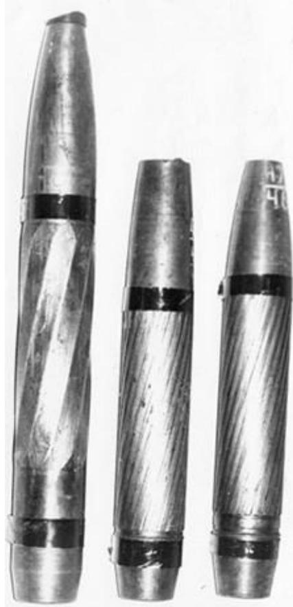
Корпуса 76-мм нарезных полигональных опытных снарядов, применявшихся для проведения опытных стрельб в 1932–1934 гг.
