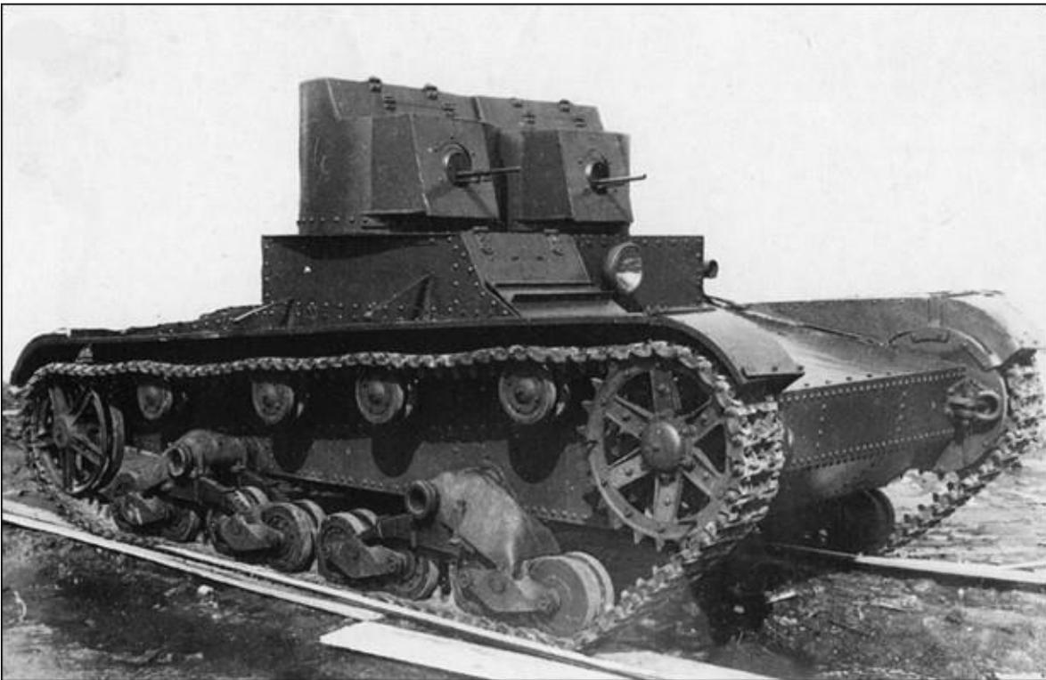
Танк Т-26 в двухбашенном варианте
