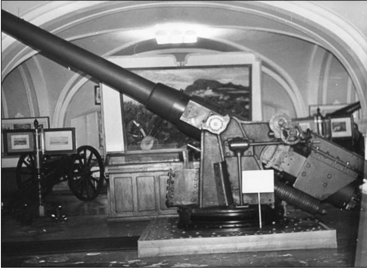
76-мм пушка длиной 100 клб, переделанная в «экстрадальнее орудие» из пушки Кане
