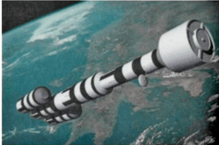
Пилотируемый корабль для полета на Марс с тремя ступенями на базе ядерного ракетного двигателя «NERVA» (к гл. 12)
