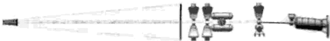
«ТМК-2», космический корабль для пилотируемой экспедиции на Марс конструкции Константина Феоктистова
