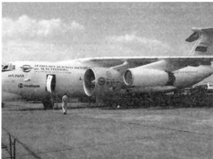
Двигатель сверхбольшой двухконтурности НК-93 на летающей лаборатории ИЛ-76ЛЛ. МАКС-2009.
