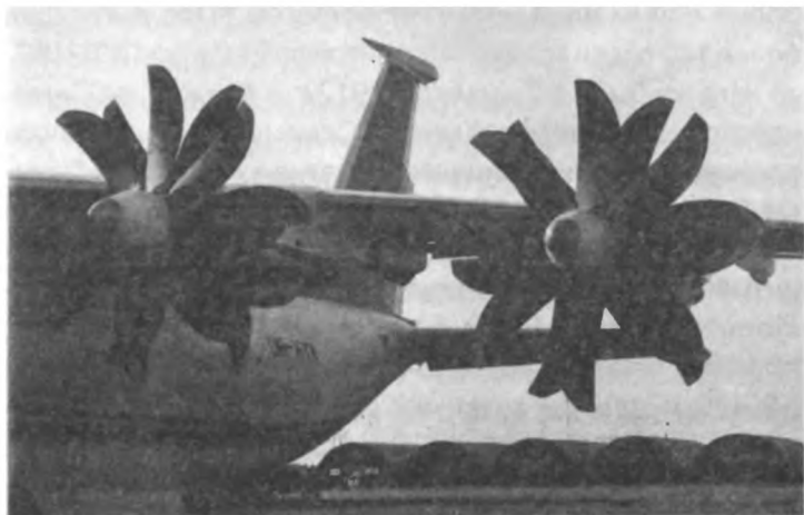
Двухрядные (8+6) винты СВ-27 ( D=4,5 м) мощностью 13.500 л.с. для самолета АН-70.
