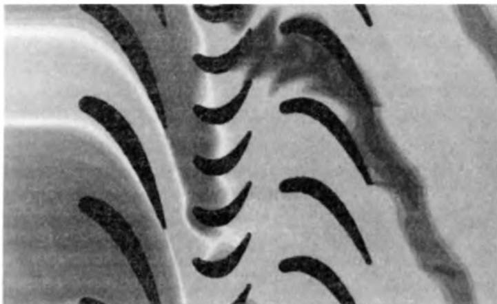
Результаты 4D-матмоделирования течения газа в колесе турбомашин: моментальное распределение температуры газа в среднем сечении межлопаточных каналов.
