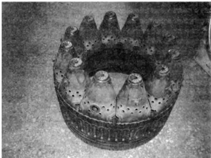
Камера сгорания немецкого БМВ 109-003 — прототип всех камер сгорания.
