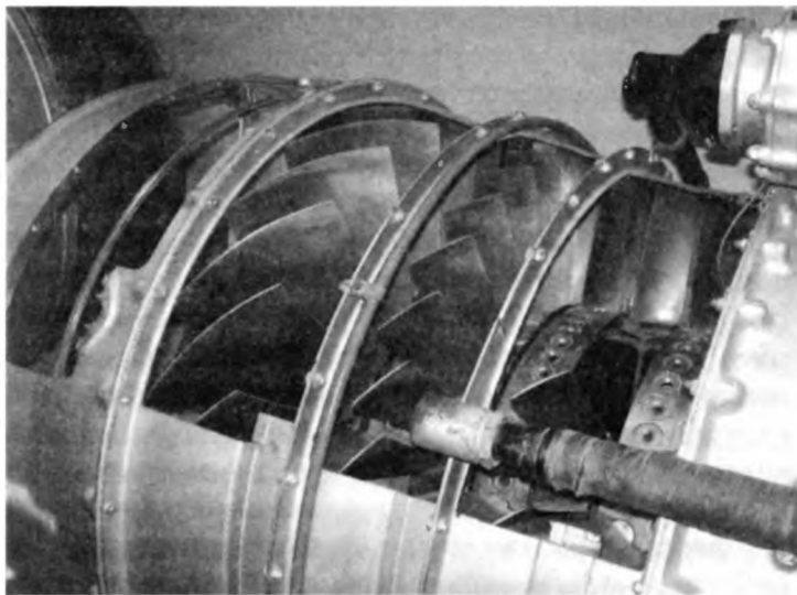
В разрезе корпуса компрессора низкого давления (вентилятора) двухконтурного двигателя Д-20П видна первая сверхзвуковая ступень — «камбала».
