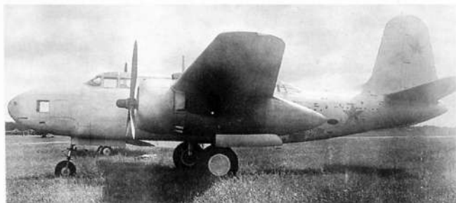
Переделка Б-3 в скоростной пассажирский самолет. Эта машина эксплуатировалась в ЦАГИ (предоставлено Г.Сидюким)
