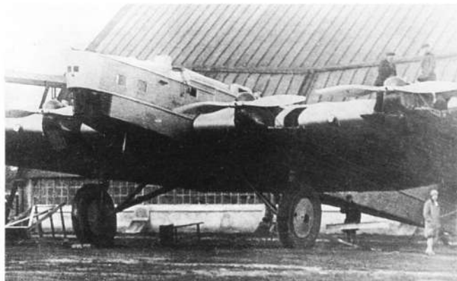
Опытный образец тяжелого бомбардировщика ТБ-3 летал с американскими моторами Кертис «Конкверор»
