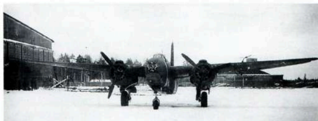
А-20G-1 в варианте истребителя с РЛС «Гнейс-3» на испытаниях (предоставлено А.Медведем)
