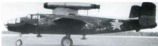
Летающая лаборатория испытаний реактивных силовых установок на базе В-25 с двигателем РД-10Ф
