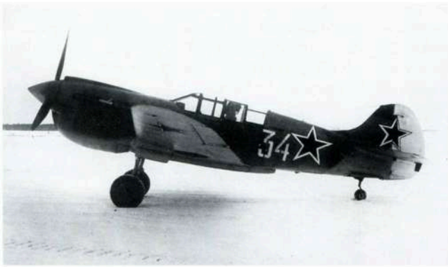
Двухместный фоторазведчик Р-40ЕФ, изготовленный 1-й авиарембазой в единственном экземпляре
