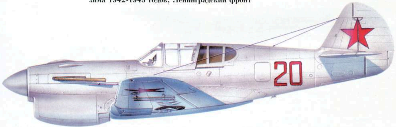
Кертисс Р-40Е, переделанный под советский мотор М-105Р, 196-й истребительный полк, зима 1942-1943 годов, Ленинградский фронт
