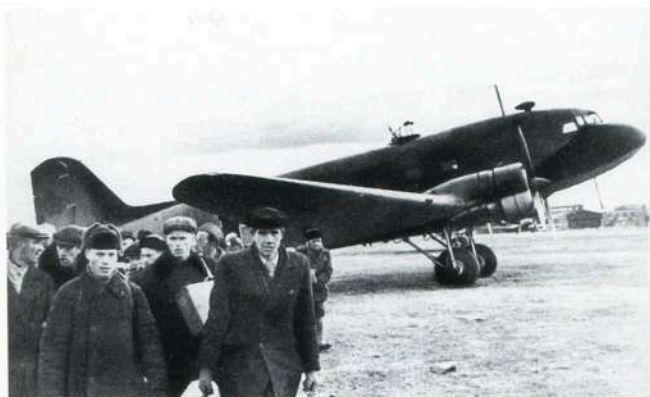
Эвакуация специалистов из блокадного Ленинграда, 1942 год. На самолете установлена верхняя турель ВУС-1 под пулемет ШКАС
