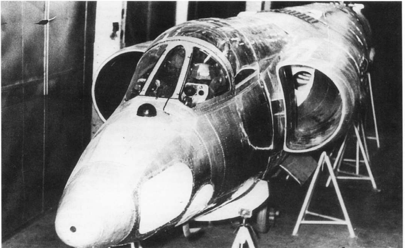
Макет фюзеляжа высотного разведчика С-13 на опытном заводе № 49 в Таганроге
