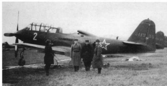
Техник звена П.Е.Викунин принимает доклад у механика самолета. Ближайшая к нам машина—УТИ P-63 на базе P-63C-5
