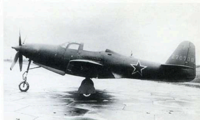
Р-63А-10, доработанный под дополнительный подфюзеляжный киль по типу модификации С, на испытаниях в Советском Союзе
