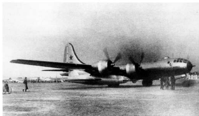
«Сверхкрепость» использовалась как носитель экспериментального самолета «346»
