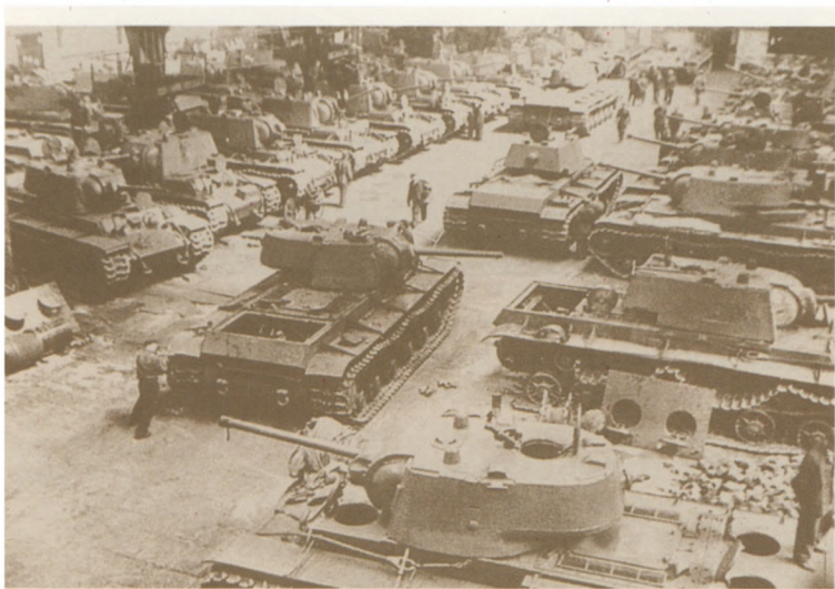
СТЕНДОВАЯ СБОРКА ТАНКОВ КВ НА ЧЕЛЯБИНСКОМ КИРОВСКОМ ЗАВОДЕ. 1942 Г.
