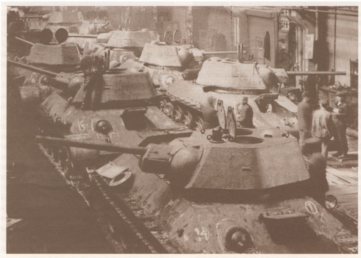
КОНВЕЙЕР СБОРКИ ТАНКОВ Т-34 ЗАВОДА №183. 1942 ГОД. Фотография из архива Музея УВЗ
