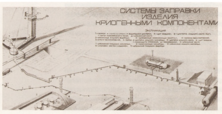
СИСТЕМА ЗАПРАВКИ РАКЕТ КРИОГЕННЫМИ КОМПОНЕНТАМИ. Фотография из архива Музея УВЗ
