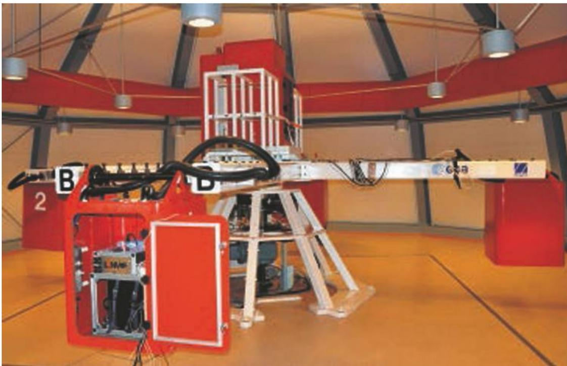
*Суперцентрифуга, установленная в центре ЕКА в Нордвике (Голландия), позволяет создавать условия сильнейших перегрузок.*
