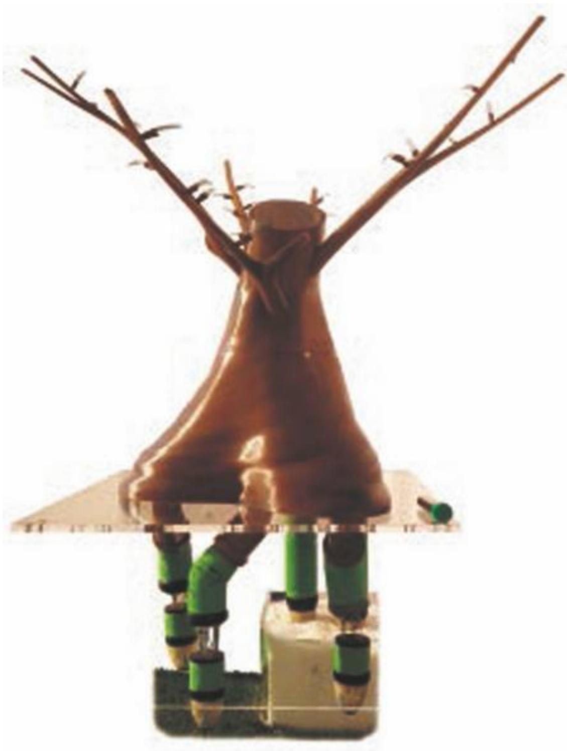
*Первый прототип плантоида, сконструированный для европейского проекта FET (Технологии будущего), погружает корни в почву.*
