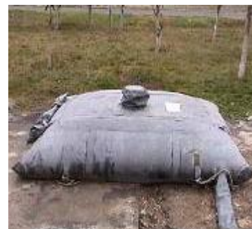
Рис.54. Резервуар для воды РДВ-1500
