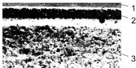
Рис. 6.21. Поперечное сечение восстановленного феррита: 1 – металлический слой; 2 – переходный (промежуточный) слой; 3 – феррит
