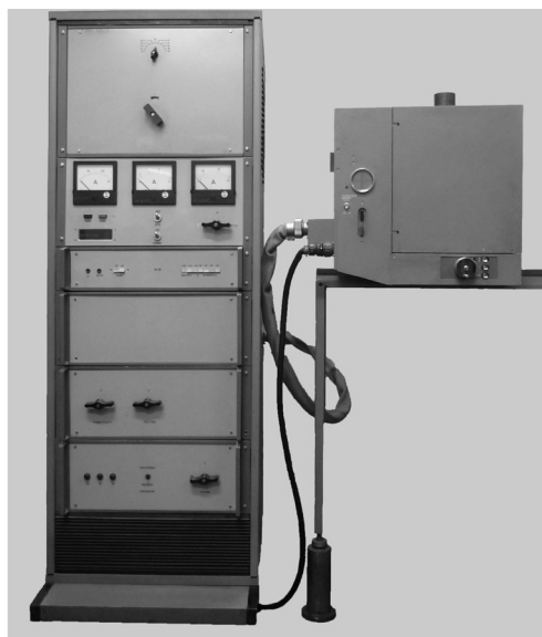
Рис. 2.3. Источник возбуждения спектров ИВС-29
