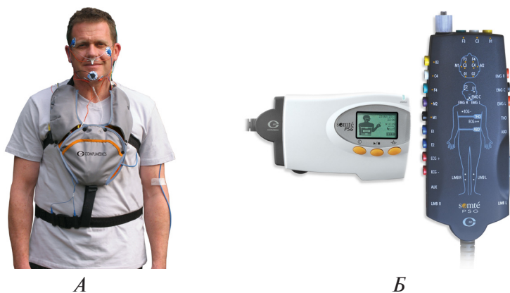
Рис. 2. 24-канальная (13 параметров) полисомнографическая система Somte PSG (Comprimedics, Австралия) с беспроводной передачей данных через bluetooth на компьютерную станцию.
