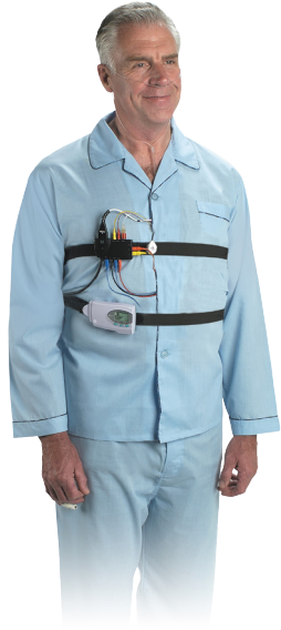
Рис 4. 13-канальная (12 параметров) кардио-респираторная система Somte (Comprimedics, Австралия)
