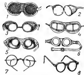
Рис. 3. Очки защитные: 1 — очки-сетка; 2 — чешуйчатые; 3 — очки Долгалева; 4 — шоферские; 5 — противоядовитые; 6 — в герметической резиновой оправе; 7 — открытого типа; 8 — открытого типа в капюльонной оправе.
