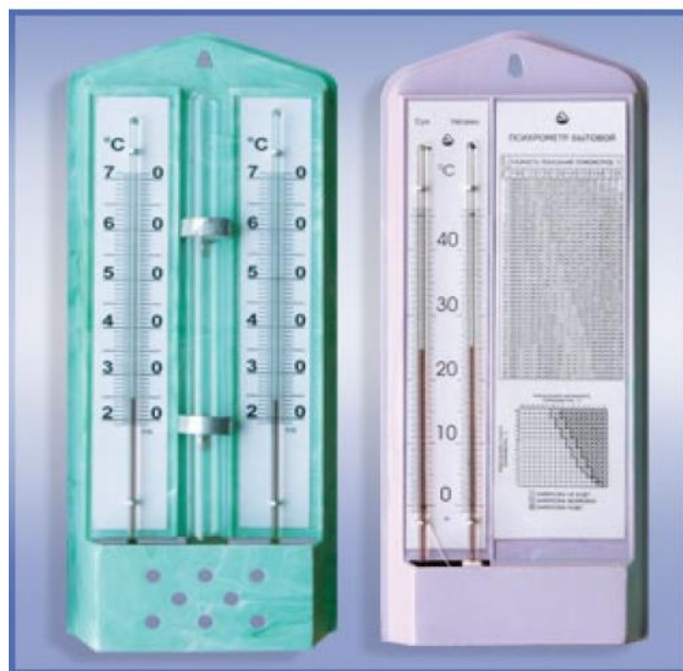
Психрометр, гигрометр и термометр – приборы для регистрации параметров воздуха
