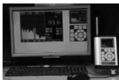
Рис. 18. Шумомер, анализатор спектра АССИСТЕНТ S
