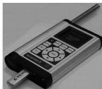
Рис. 19. Шумомер, анализатор спектра АССИСТЕНТ SI
