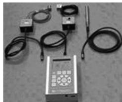
Рис. 26. Шумомер, анализатор спектра ШИ-01
