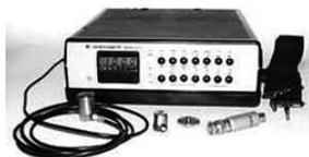
Рис. 27. Измеритель параметров вибрации ВВМ-311
