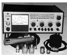
Рис. 15. Измеритель шума, вибрации, инфразвука и ультразвука ВШВ-003-М3
