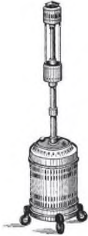
Рис. 17. Ультрафиолетовая установка для фотариев маячного типа с использованием лампы ПРК.
