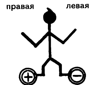
Рис. 13. Полярности электродов при четырехквadrантных измерениях
