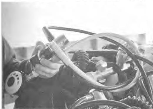
Соединение струбциной YOKE менее надежно, нежели резьбовое соединение DIN.
