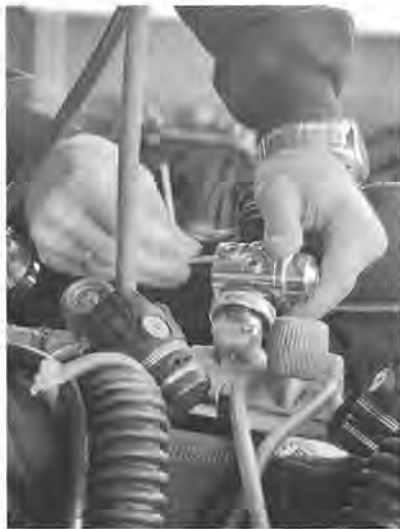
Проверка герметичности заглушек портов на первой ступени регулятора.
