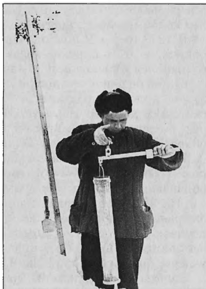
А. Н. Олиферов измеряет плотность снега во время снегосъемки на стационаре «Ферма» в урочище Большой Бабулган на Ай-Петринской яйле
