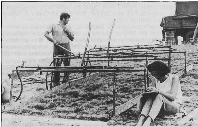
Дождевальная установка для изучения стока и смыва площадью 6 \text{ м}^2
