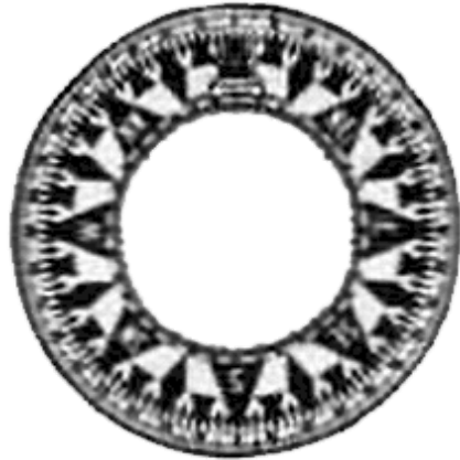
Картушка компаса, разбитая на 32 румба и 360 градусов
