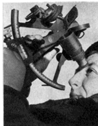
Современный угломерный инструмент - секстан
