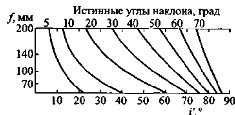
Рис. 8.1. Номограмма для определения истинных углов наклона местности по видимым углам
