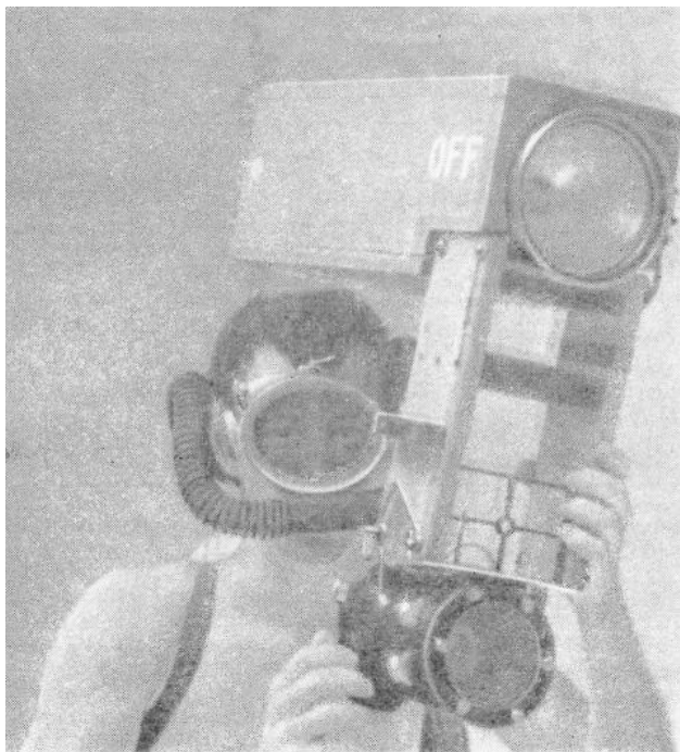
Рис. 31. Бокс фирмы «Акустише унд Кино-Герэте» для фотоаппарата «Лейка» и электронный импульсный прибор в водонепроницаемом корпусе. Деревянный кожух, в который заключен прибор, служит для предохранения его от повреждений на поверхности. Обратите внимание на то, что угол между оптическими осями аппарата и прибора можно регулировать для съемки крупным планом или с большего расстояния. (Снимок из собрания д-ра Г. И. Эджертон)
