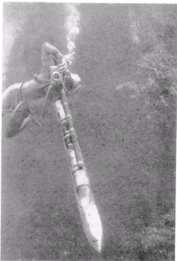
Рис. 61. Электронный импульсный прибор «Торпеда», сконструированный М. Ребиковым из г. Канн (Франция). Обратите внимание на то, как далеко вперед по направлению к снимаемому объекту вынесен источник света, установленный почти в самом конце длинного цилиндра. Глубина 38 м; пленки «Плюс X»; диафрагма 6,3; \frac{1}{100} камера «Фока». (Снимок фирмы «Фока Х. Бруссар»)
