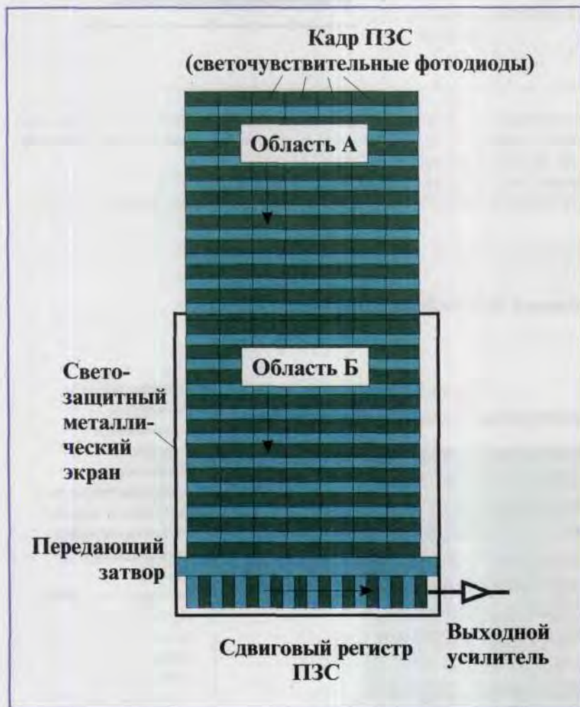
Рис. 16 Схема работы ПЗС-матрицы с кадровым переносом
