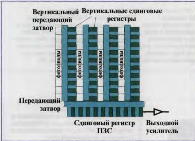
Рис. 17 Схема работы ПЗС-матрицы с чересстрочным считыванием
