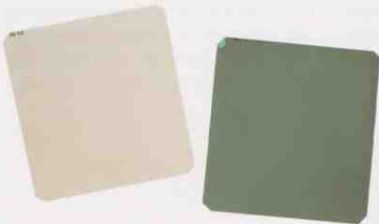
▲ ND-фильтры серого цвета. Чем плотнее фильтр, тем темнее серая тональность фильтра. На этом снимке вы видите ND-фильтры с плотностью x4 и x16. Они понижают количество света на 2 и 4 ступени соответственно.
