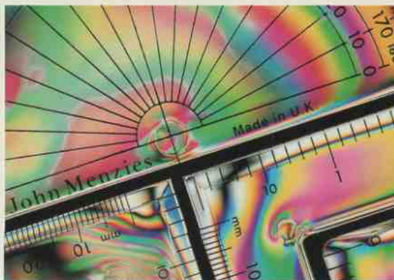
◀ Кросс-поляризация Такой эффект можно получить, сняв кусок деформированного пластика с помощью двух PL-фильтров.
