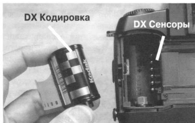
Камера автоматически считывает значение ISO с картриджа пленки (DX кодировку). Это происходит при контакте серебристых секторов картриджа с сенсорами камеры.
