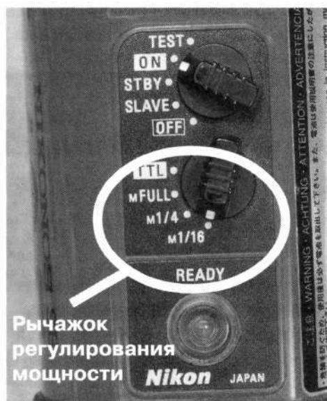
Подводная вспышка с режимом регулирования мощности.
