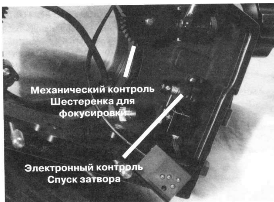
Подводный бокс для камеры с электронным и механическим контролем.
