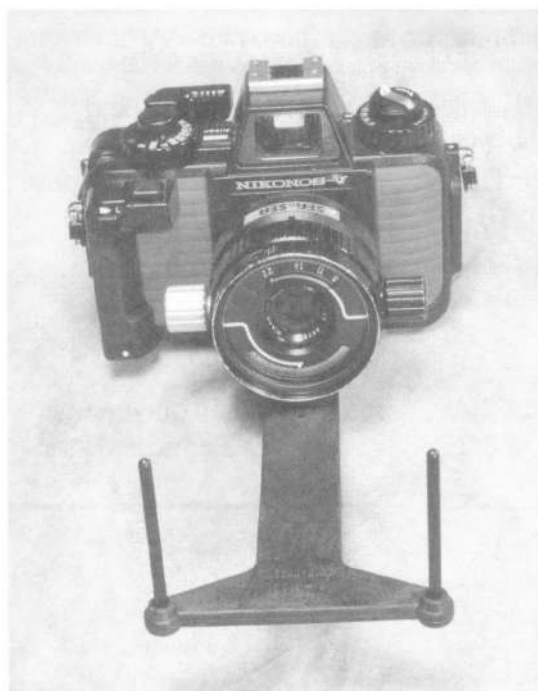
Фотоаппарат с выдвинутой рамкой для макросъемки. Использование рамки позволяет точно сфокусировать объектив.
