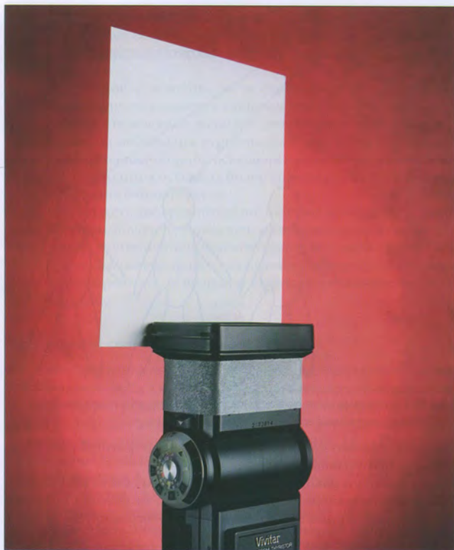
Рис. 10.2. Небольшая карточка-отражатель для заполняющего света, прикрепленная к вспышке, уменьшит тени на лице, возникающие из-за отражения света от потолка
