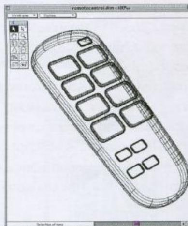
**1** Эту модель было несложно создать в Dimensions: к контуру пульта была добавлена изогнутая фаска для эффекта скругления. Затем модель была сохранена в двух частях: сначала были спрятаны кнопки, модель была визуализирована как изображение в PostScript, а затем сохранена как EPS-файл. После этого она была скрыта, а кнопки отображены и экспортированы как отдельный слой.
