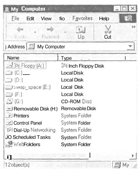
Рисунок 5.5. Считывающее с карт устройство - Съемный диск H: отображается в папке Мой компьютер (My Computer) так, будто это еще один дисковод
