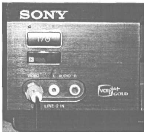
Рисунок 5.17. Большинство видеомагнитофонов имеют видеовыход на передней панели
