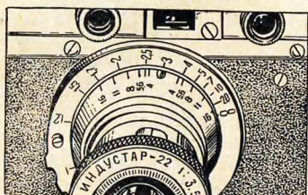
Рис. 19. Шкала глубины резкости на объективе «Индустар-22»
