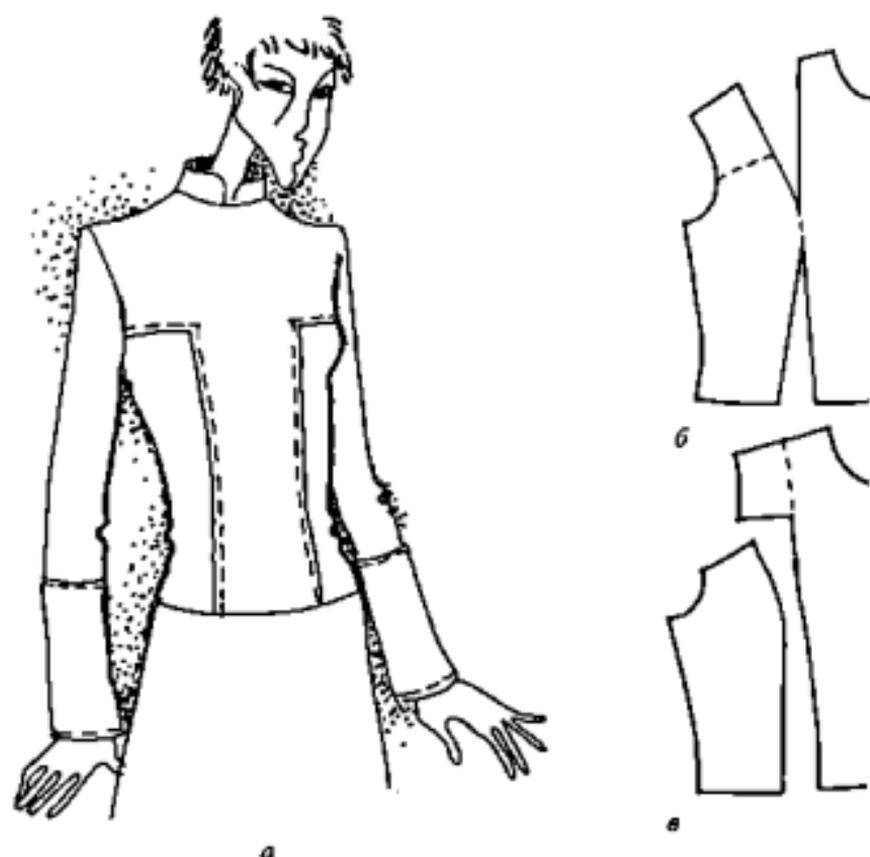
**Рис. 49.** Схема образования прямоугольного рельефа, выходящего из линии проймы:
