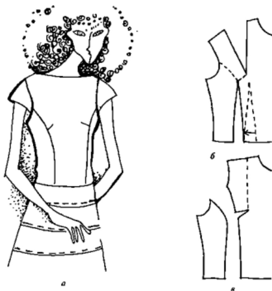
Рис. 50. Схема образования рельефа с частичным сохранением нагрудной вытачки:
