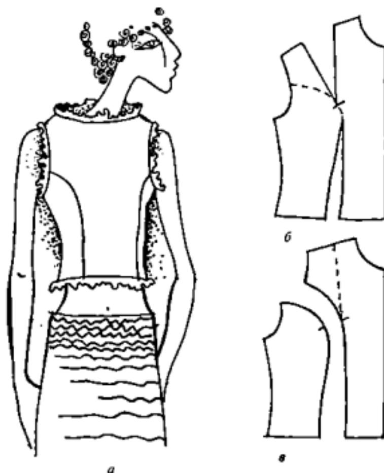
Рис. 48. Схема образования круглого рельефа, выходящего из линии проймы:
