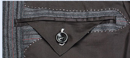
Бортовая прокладка пришита вручную, а не приклеена
