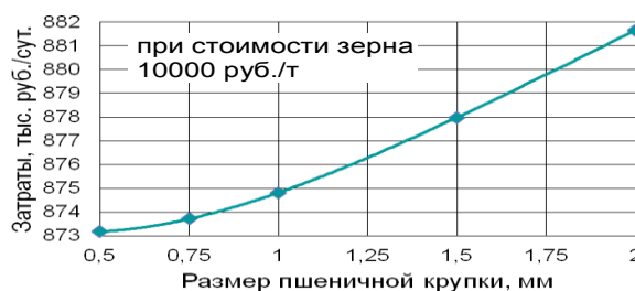
Рисунок 3 – Зависимость затрат от размера пшеничной крупки при низкотемпературном разваривании
