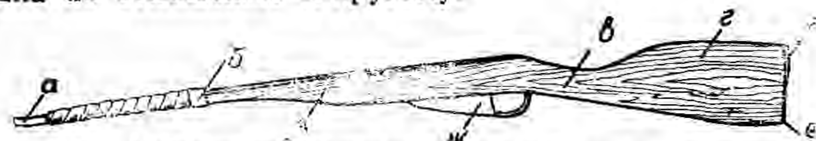
Рис. 1. Общий вид фехтовального карабина: а — дульная часть ствола, на которую надевается штык; б — нижнее ложевое кольцо; в — шейка приклада; з — приклад; д — затылок приклада; е — острый угол приклада; ж — магазинная коробка; з — цевье
