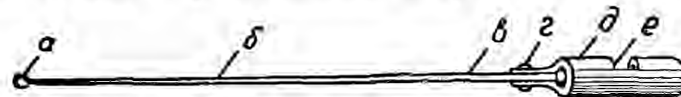
Рис. 2. Эластичный штык: а — предохранительная часть острия; б — слабая часть клинка; в — сильная часть клинка; з — крепление клинка к трубке; д — штыковая трубка; е — продольный и поперечный пазы для прохождения основания мушки при надевании штыка на дульную часть ствола
