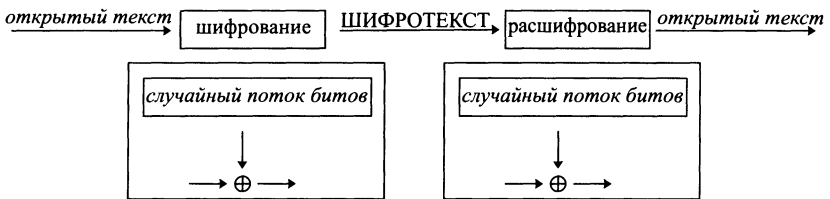
Рис. 5.1. Упрощенная модель, шифрующая строку битов
