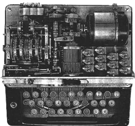
Рис. 8.2. Электромеханическая шифрмашинa B-211 шведской фирмы «Aktibolaget Cryptoteknik» с русифицированной клавиатурой
