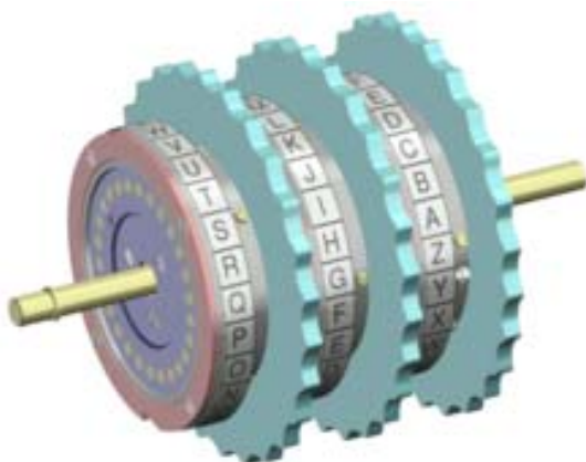
Рис. 10.2. Три последовательно соединенных ротора «Энигмы»
