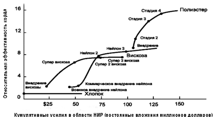
Рис. 9.2. Разрывы непрерывности при совершенствовании материалов для шинного корда
