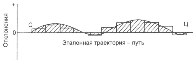
Рис. 1.2. Интегральный критерий качества автоматического управления (заштрихованная площадь)
