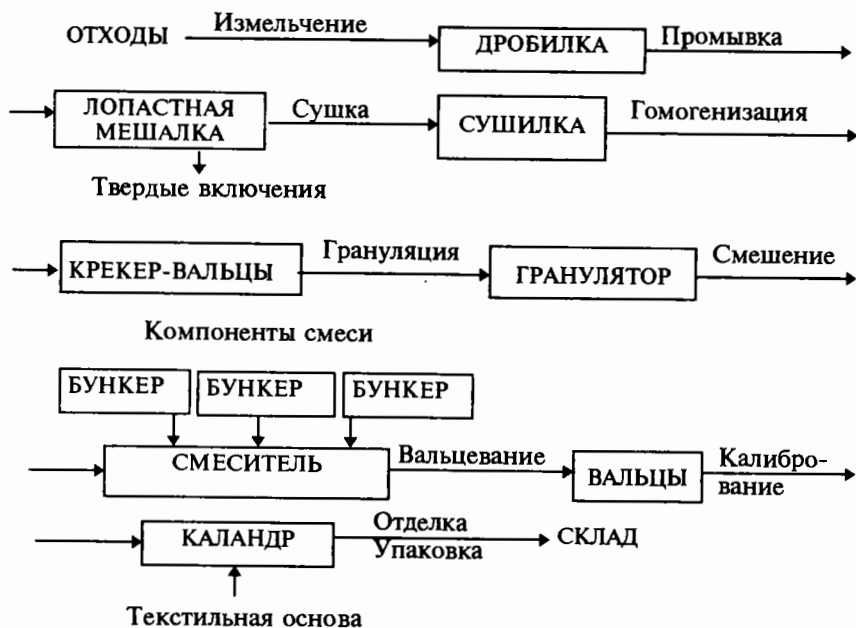
Рис. 9.11. Схема регенерации отходов искусственной кожи и пленочных материалов
