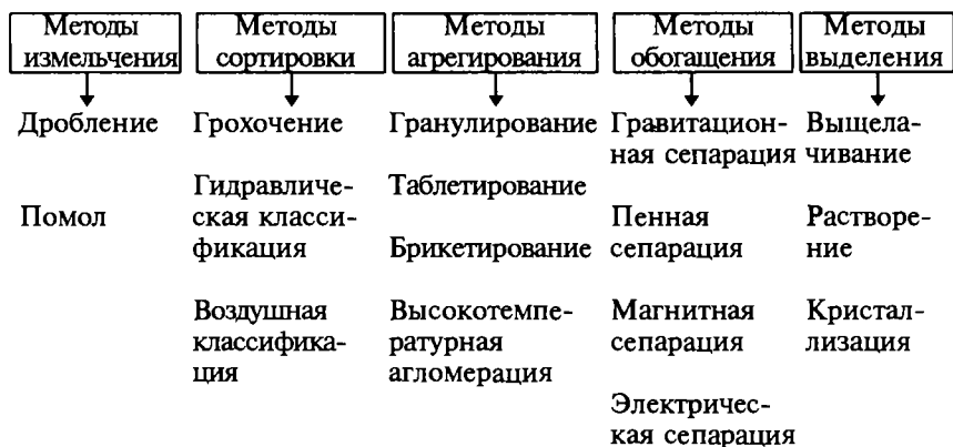
Рис. 4.1. Наиболее распространенные методы подготовки твердых отходов к переработке
