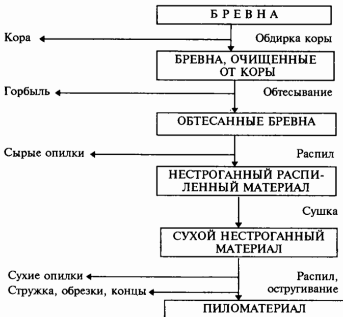
Рис. 11.1. Технологическая схема лесопильного производства
