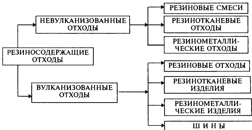
Рис. 9.14. Классификация резиносодержащих отходов
