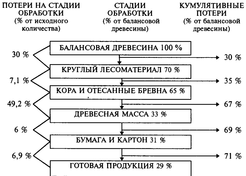
Рис. 12.1. Технологические потери при производстве бумаги и картона из древесины
