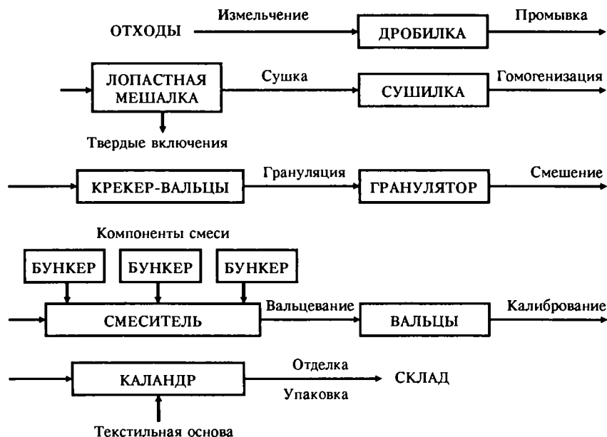
Рис. 11.4. Схема регенерации отходов искусственной кожи и пленочных материалов
