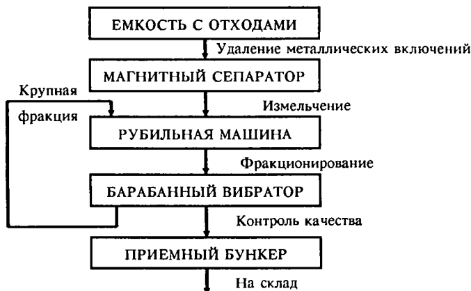
Рис. 13.2. Технологическая схема производства щепы
