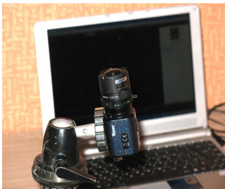
Рис. 8. Камера Wat-902H с широкоугольным объективом T2314FICS. Поле зрения системы 129X99 град.
