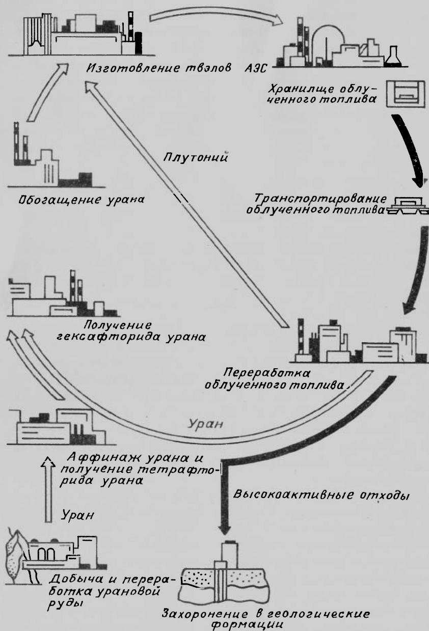
Рис.1.1. Схема ядерного топливного цикла, включающего получение и применение ядерного топлива
