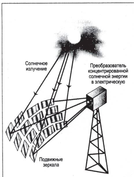
Рисунок 16.14 — Схема солнечной энергетической установки башенного типа (по Б. Лучкову, 2002)
