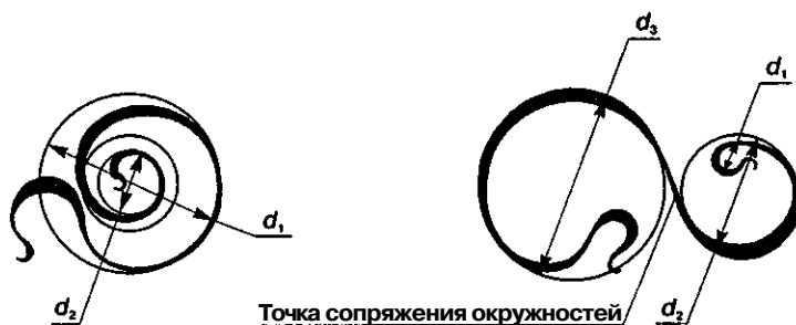
Рис. 3. Сопряжение дуг окружностей
