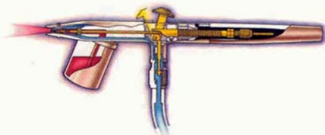
Схема аэрографа Модель С-1 фирмы «Эфбе» (Efbе Hobbyist Model С-1). Пусковым рычагом перемещается только вперед и назад, что, однако, позволяет получить линии всех типов и струю разной ширины.
