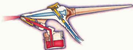
Схема аэрографа Бэджер Зу (Badger Zoo); это аэрограф одинарного действия со сменной стеклянной емкостью для краски. Толщина линий зависит от интенсивности воздушного потока. Чем ниже давление и чем ближе аэрограф к поверхности бумаги, тем тоньше получится линия.
