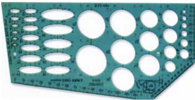
Пластмассовый шаблон с эллипсами: помогает чертить эллипсы разной величины в аксонометрии
