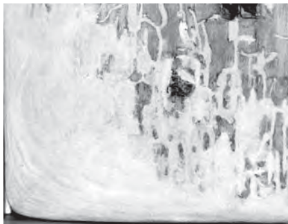
Ил. 45. Крупная утрата древесины, заполненная смесью рыбьего клея с опилками
