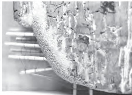
Ил. 44. Каркас для восполнения крупных утрат древесины
