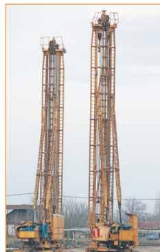
Оборудование, используемое для вдавливания свай
