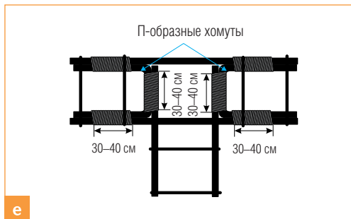
е Т-образное сопряжение накладкой П-образных хомутов
