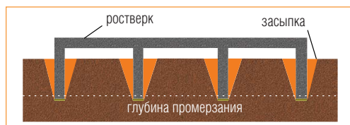
Схема устройства высокого ростверка
