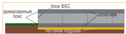
Схема укрепления фундамента с помощью нижнего и верхнего армированных поясов
