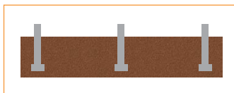
Схема расположения элементов столбчатого фундамента на ровных участках
