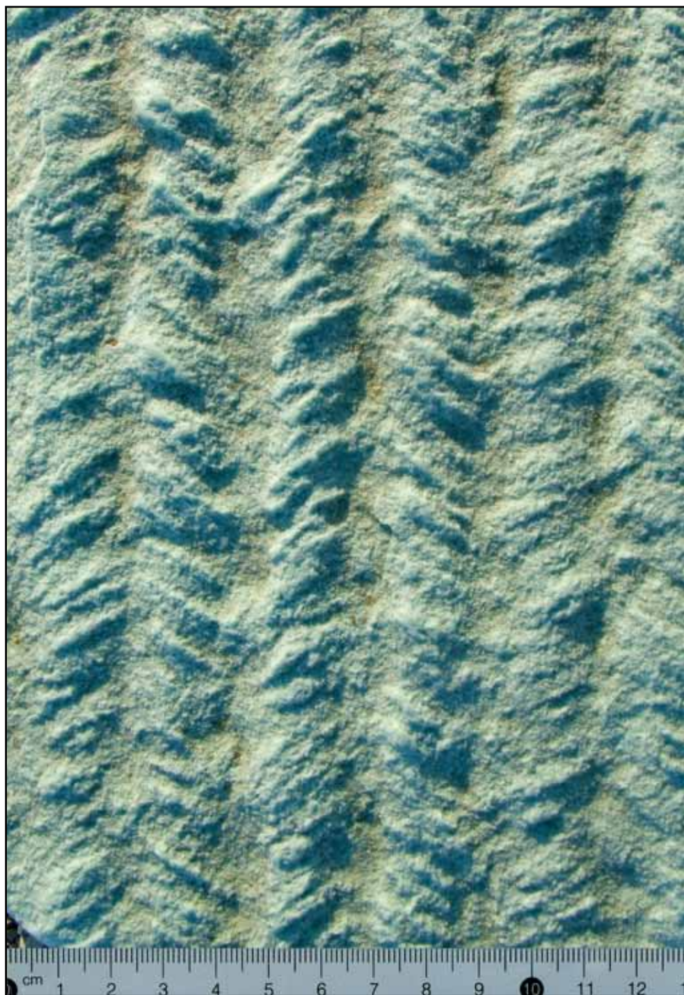
Фото 138. Полимерный слепок с орнамента порталной плиты (фото 67) в масштабе 1:1 позволяет судить о структуре и взаимном расположении волокон.
