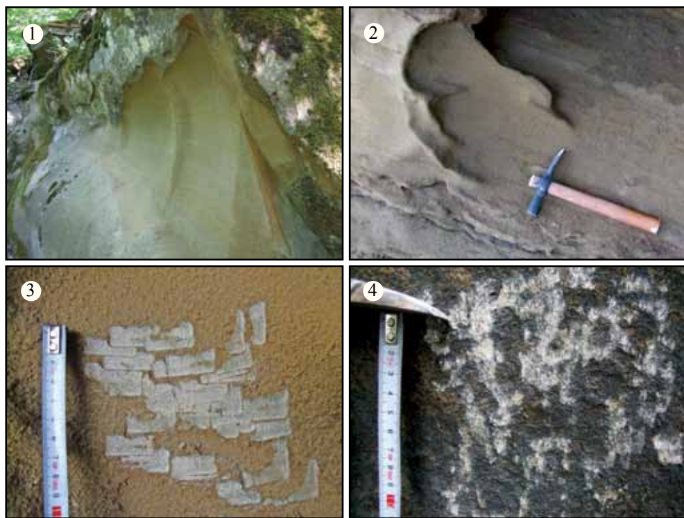
Фото 101. Скальные выходы песчаника в районе пос. Пшада: 1. Сверху и снизу скала представлена прочным песчаником, он стойко противостоит воздействию внешних факторов и покрыт слоем окислов и лишайников. В средней части песчаник обладает очень низкой прочностью (1,9 МПа), легко крошится под пальцами и осыпается. 2. Тесовик на песчанике очень низкой прочности. Постоянно осыпающаяся поверхность песчаника не покрывается окислами и не зарастает лишайником. 3. Следы затесов на песчанике от тесовика. Обратите внимание на рыхлую текстуру песчаника. 4. Прочный песчаник (66,1 МПа), обработанный тем же тесовиком. Поверхность выравнивается, но следов затесов от инструмента на прочном песчанике не остается.
