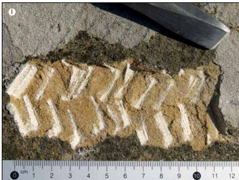
Фото 144. Результат попыток получить рисунок «елочка» на песчанике с использованием современного скарпеля: 1. Сколы от лезвия скарпеля образуют чешуйки, которые, соединяясь с соседними сколами, образуют выемку камня на глубину скола 1—2 мм. Сравните с фото 132-1. 2. След, оставленный единственным ударом молотка по скарпелю. Хорошо видно формирование чешуйчатого скола во все направления. 3. Еще одна попытка скарпелем нанести узор «елочка» на песчаник.
