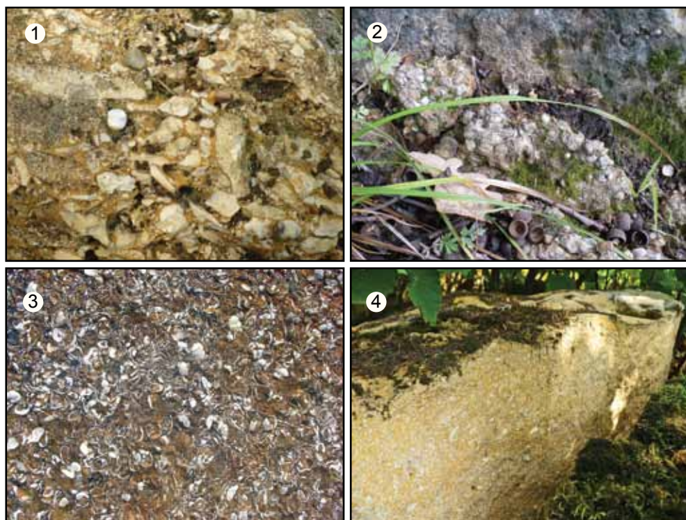
Фото 59. Богатырские поляны: 1. Полимиктовая брекчия (образец горной породы из района Богатырских полян). 2. Песчанистый известняк (образец породы с Богатырских полян). 3. Боковая плита дольмена (песчанистый известняк). 4. Фрагмент расколотого перекрытия дольмена (песчанистый известняк).
