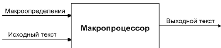
Рис. М.2. Схема работы макропроцессора
