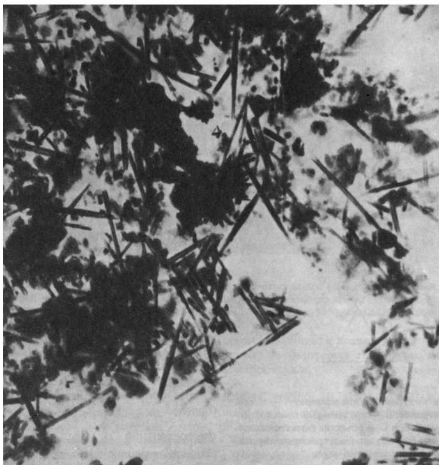
Смесь галлаузита (трубки) и кристаллитов каолинита (электронный микроскоп: увел. 9750 × — железистая почва, Нижний Заир). Фото Ж. Ступса.
