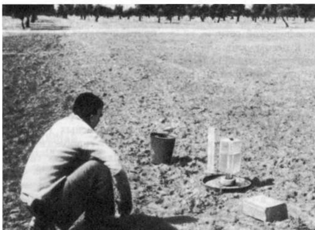
Определение водопроницаемости в полевых условиях методом Мюнца—Лена с помощью двойного кольца. Оператор измеряет количество воды, инфильтрующееся в единицу времени. Фото С. Матве.
