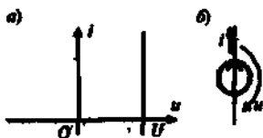
Рис. И.8. Вольт-амперная характеристика (а) и условное графическое обозначение (б) источника напряжения
