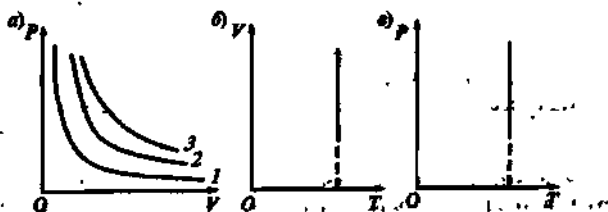
Рис. И.3. Графическое представление изотермического процесса в газах на P - V (а), V - T (б) и P - T (в) диаграммах.
