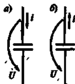
Рис. К.2. Условное графическое обозначение конденсатора и направлений отсчета напряжения и силы тока: согласного (а) и встречного (б)
