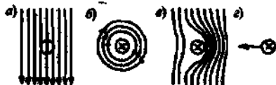
Рис. А.3. К определению направления движения провода с током во внешнем магнитном поле
