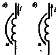
Рис. И.6. Условное графическое обозначение индуктивной катушки и направленный отсчет напряжения и силы тока: согласного (а) и встречного (б)
