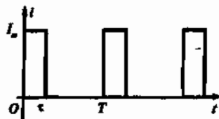
Рис. Д.4. Временная диаграмма периодической последовательности прямоугольных импульсов
