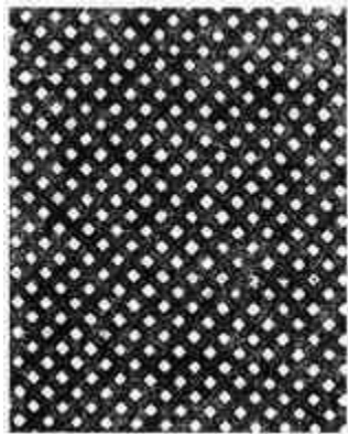
Схема автотипного растра для высокой и офсетной печати
